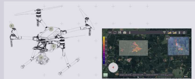
Robottos droneplatform AWRA (Autonomous Wildfire Recognition and Analytics platform). Platformen sender oplysninger om brandens størrelse og retning til brugeren, som derefter kan tilpasse indsatsen og bekæmpe branden mere effektivt end tidligere.
