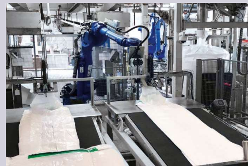
PanPac Engineering udvikler og producerer forskellige fuldautomatiske palletteringsrobotter, sækkefyldere, mm. På billedet ses PanPac Engineering's bigbag-fyldesystem, der med robotter kan fylde og lukke sække.
